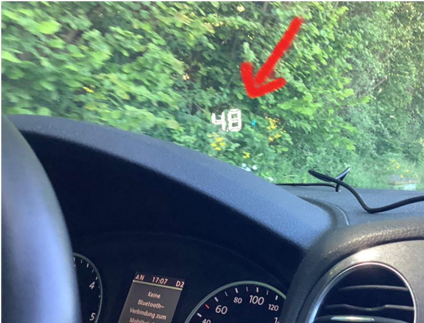
Abbildung 4-8: Einbau-HUD (Foto: Alexander Niederländer)
